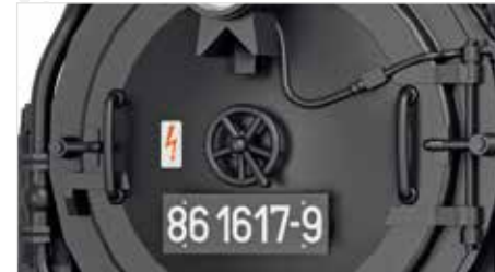
Aufwendig umgesetzte Rauchkammertür
