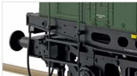
Freistehende Griffstangen an den Aufstiegen
