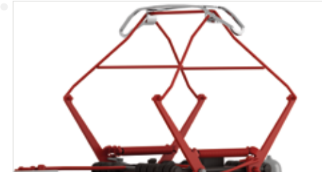
Zierlicher Stromabnehmer der Bauart SBS 54/10 mit unsichtbarer Befestigung
