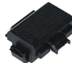
35272 Gleiskontakt 22,50 €* Kontakt zum Schalten von Weichen, Signalen und Zubehör, ausgelöst mit dem Lokmagnet #35269 Track Contact Single-pole double-throw momentary reed-switch contact for controlling switches, signals and other accessories, triggered by the loco magnet # 35269
