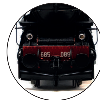
Vomere ripiegabile frontale, fanali elettrici funzionanti
