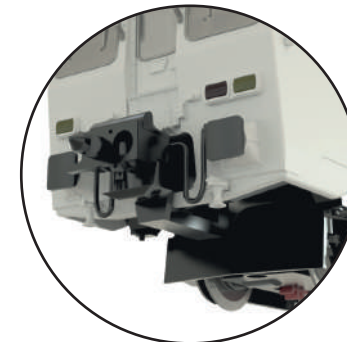
Enganche frontal intercambiable, funcional
