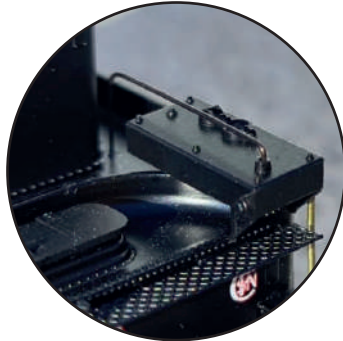
Réservoir à T.I.A sur le tender
