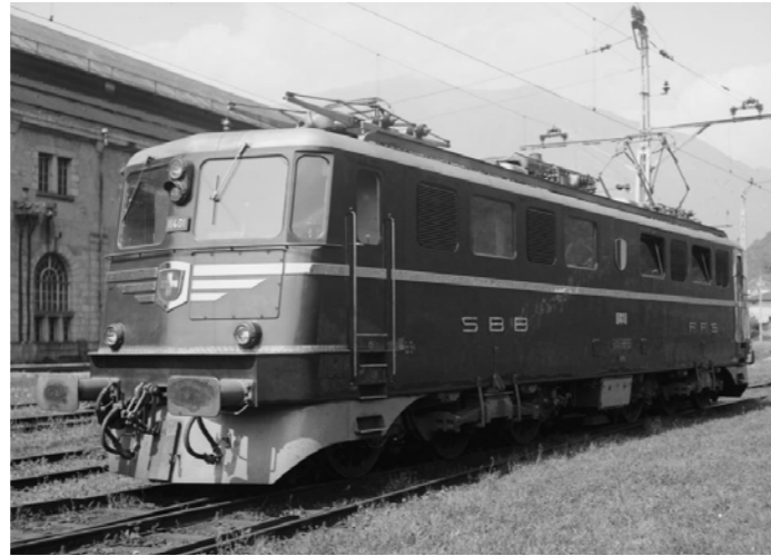
Prototyp Ae 6/6 11401 Ticino im Ursprungszustand Bild: Archiv SBB Historic
