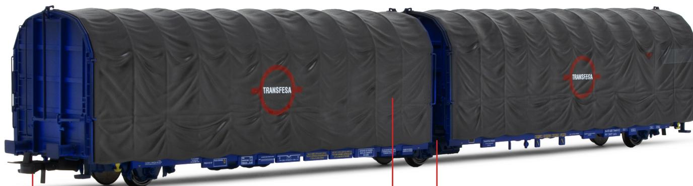
Ganchos conformes a la norma NEM 362 con barra de tracción en los extremos
