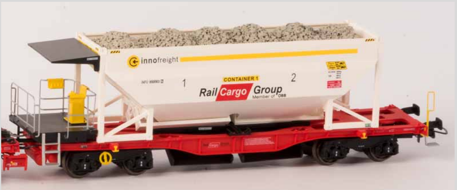
InnoFreight Infra Rocktainer mit Beladung
