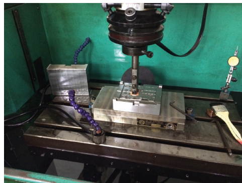
Formenbau für ABS-Teile
